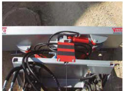
Niveladora con dos cilindros hidráulicos de doble efecto para la angulación hidráulica de izquierda/derecha y un cilindro de doble efecto para la oscilación hidráulica, tubos de goma y acoplamientos rápidos de 1/2" para la alimentación del circuito hidráulico, kit de enganche universal para la cargadora compacta.
